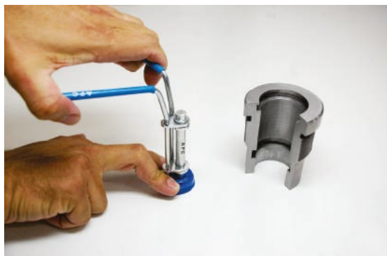
3) Posicionando a gaxeta e travando o alicate
